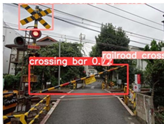
＜カメラ画像からのAIによる障害物自動認識の例＞
