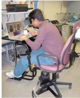
モーターとスピーカーが組み込まれた回転椅子。パソコンとつなげて様々な研究に使用されている
