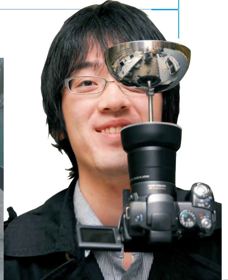
ステンレスのお玉(シャモジ)を利用した360度撮影用の反射鏡
